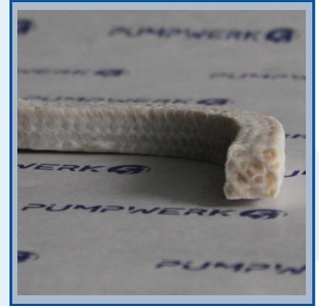
Wir empfehlen bei der Verwendung von Packungen generell Wellen oder Wellenschutzhülsen mit einer Oberflächenhärte von 50-60 HRC zu verwenden.
